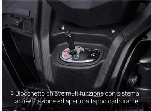
◇ Bloccetto chiave multifunzione con sistema anti-effrazione ed apertura tappo carburante
